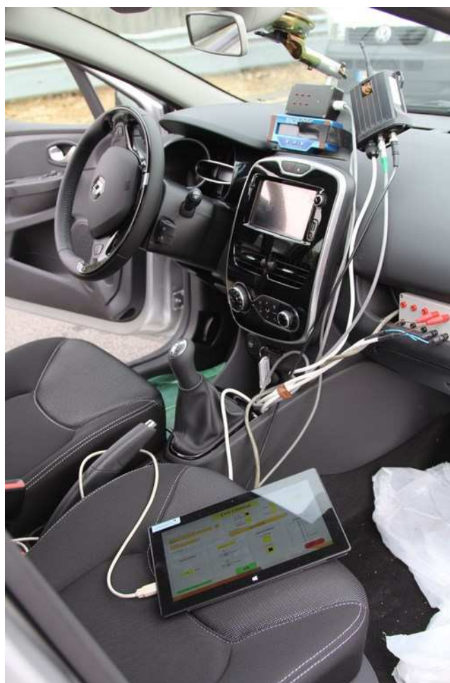
Illustration 4 : Clio instrumentée (Source Cerema, 2015)
