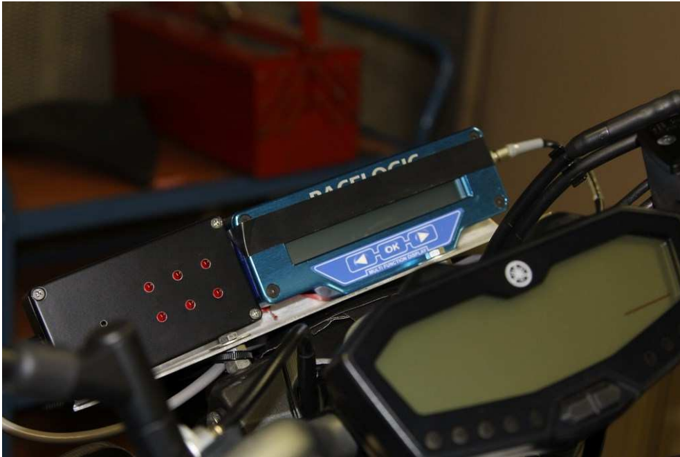
Illustration 5 : top visuel 2x3 leds rouges et indicateur de vitesse installés sur la Yamaha (Source Cerema, 2015)
